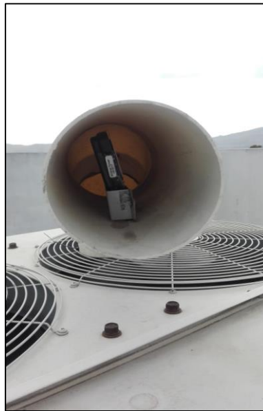
Figura 19: Datalogger colocado para la medición de temperatura
