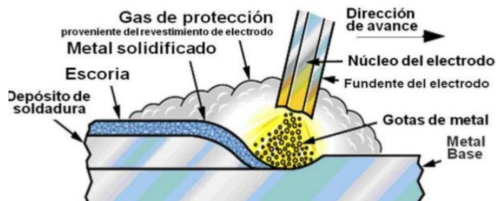
Figura 12. Proceso de soldadura eléctrica
