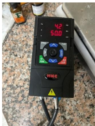
Imagen 4. Variador de frecuencia defectuoso Elaborado por: Heredia, Bryan (2024).
