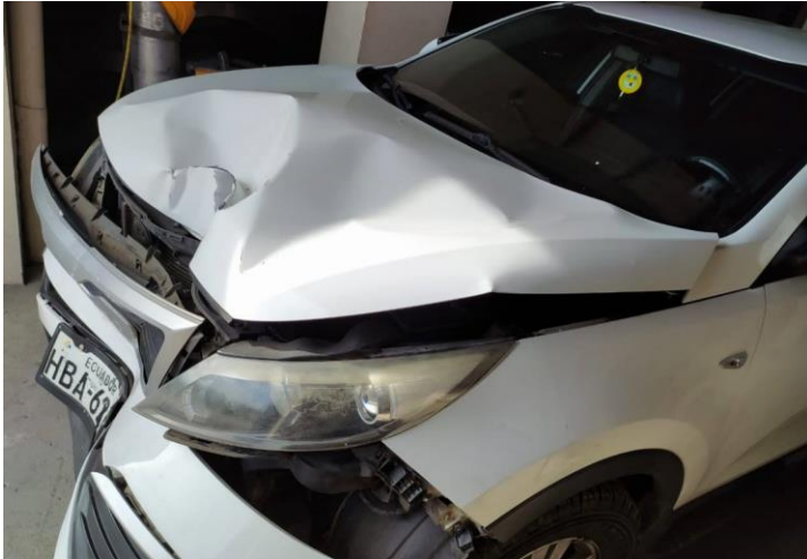
Imagen 1: La imagen uno representa que no es factible enderezar el capo lo más rápido y menos costoso es el cambio de pieza
