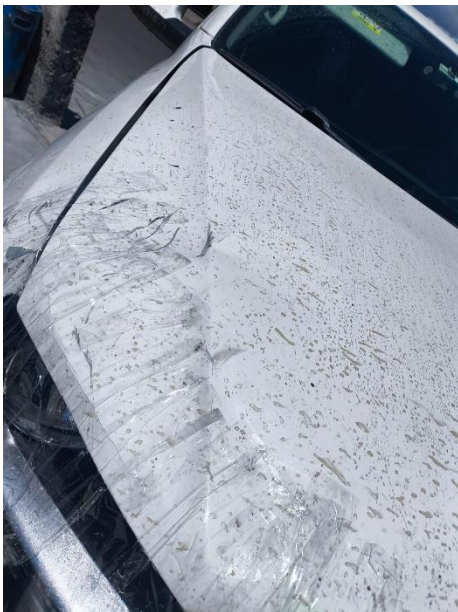
Imagen 1: La imagen uno representa que no es factible enderezar el capo lo más rápido y menos costoso es el cambio de pieza
