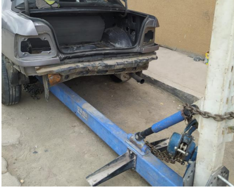
Imagen 2: Anclaje de vehículo
