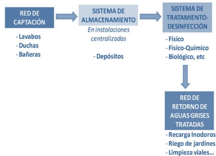
Figura 104 Sistema de captación de agua Fuente: (Rull, 2018)
