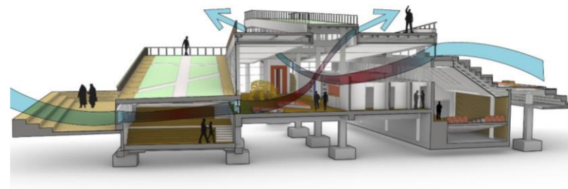
Figura 132 Diagrama de Ventilación Natural- Ventilación Cruzada
