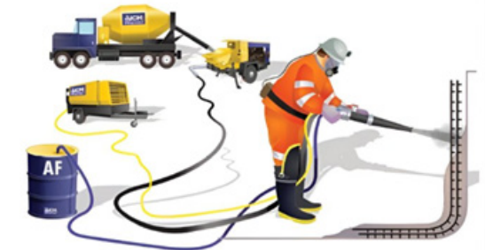
Figura 74. Inyección de hormigón proyectado
