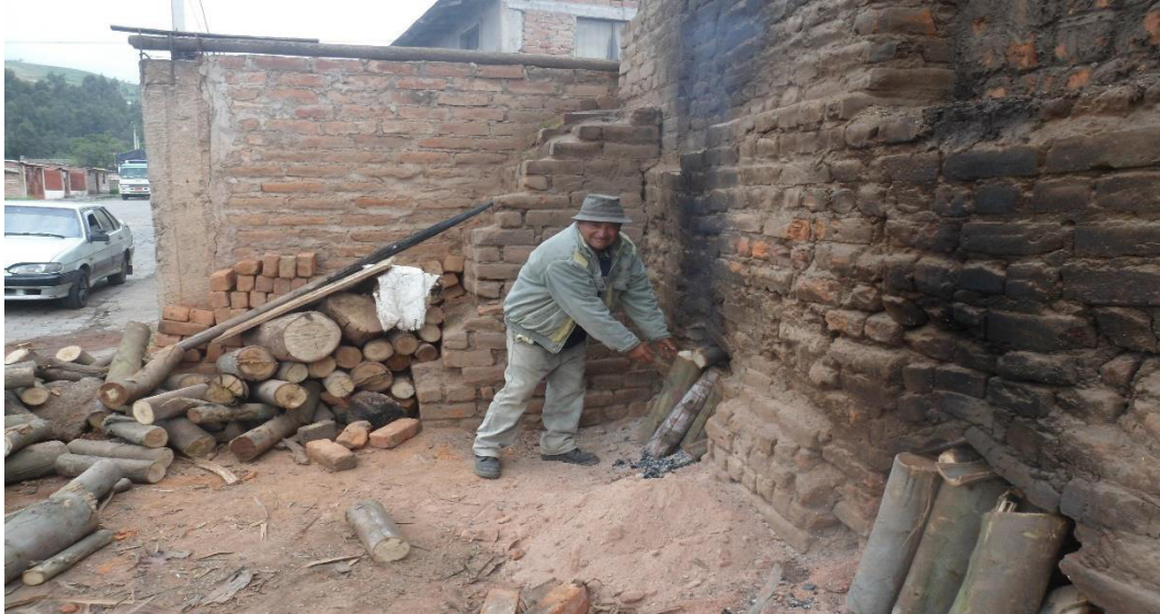
Imagen 10: Cocinado del ladrillo Fuente: Chuqui (2019)
