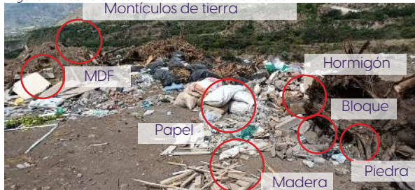
Figura.24. Señalar los materiales de construcción. Montículos de tierra
