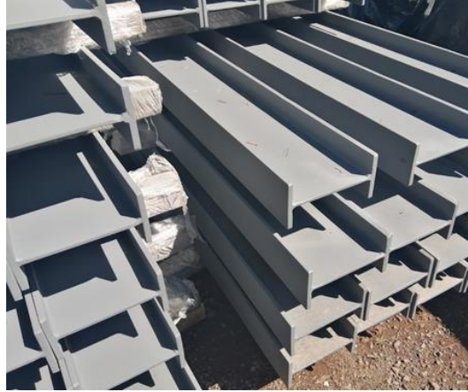
Imagen No. 5: Inspección visual de perfiles estructurales acero ASTM A588.
