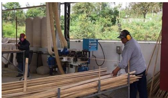
Figura N° 17: Cepillado cuatro caras Fuente: Central del bambú Andoas (CENBA) Elaborado por: Bryan Bedón
