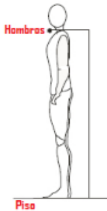
Figura 27. Posición del trabajador para medir la altura de los hombros del trabajador
