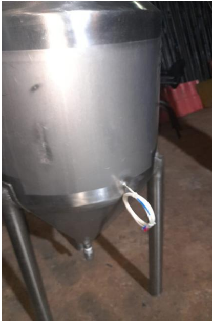
Figura 16 Colocación del sensor de temperatura P,100
