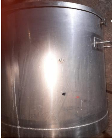
Figura 13 Perforación en la olla de macerado
