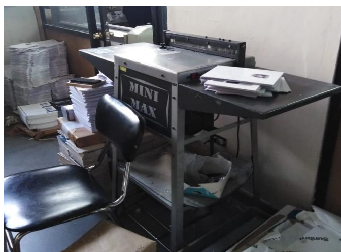
Figura 13: Perforadora Fuente: Nuevo Arte S. A Elaborado por: El Investigador
