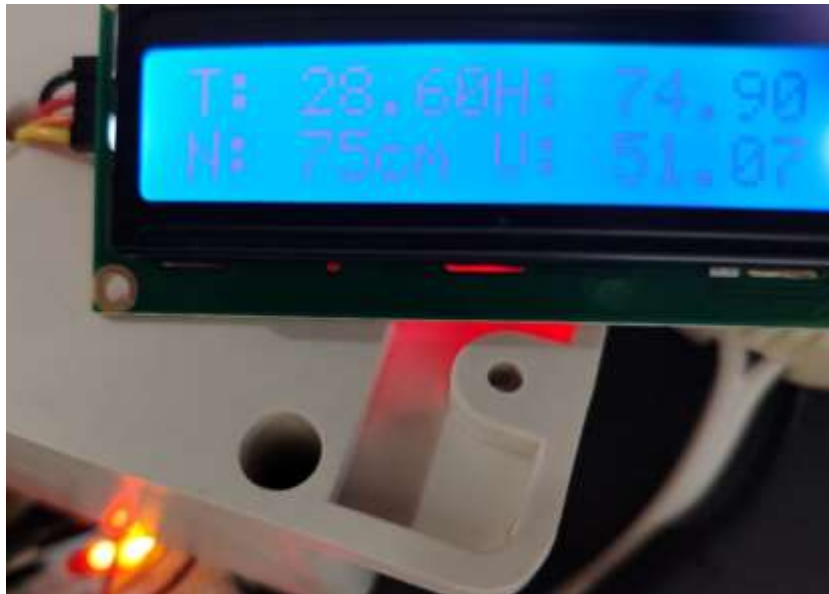
Anexo 12 Imagen de los focos amarillo y naranja prendidos ( rango entre 50 y75C)
