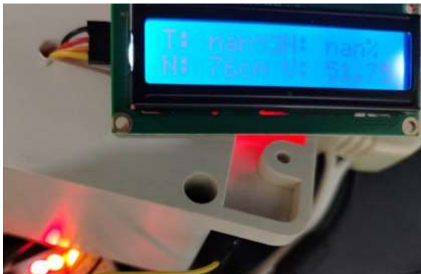
Anexo 13 Imagen de los focos amarillo, naranja y rojo, prendidos (nivel de aceite mayor de 75cm)
