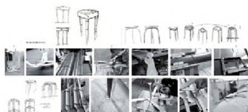
Figura 30. Curvado mediante latilla y calor. Fuente: José Jaramillo (2018).
