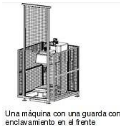
Figura 13. Guardas con dispositivo de enclavamiento y bloqueo de guarda
