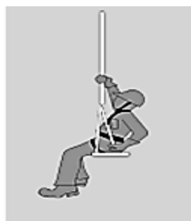
Sistema de ascenso/descenso controlado
