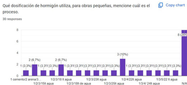
Figura 31: Cuadro de dosificaciones usadas en obra.
