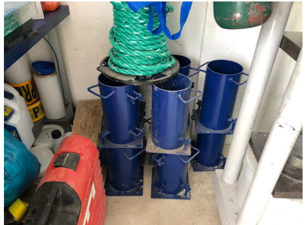
Figura 46: Cilindros para muestras de hormigón.
