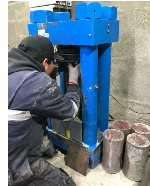
Figura 48: Muestras de Hormigón y Maquina compresora.
