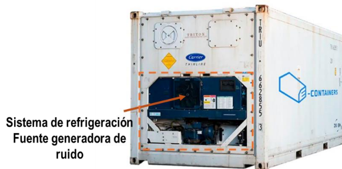
Ilustración 24 Contenedor actual con sistema de refrigeración dentro del contenedor
