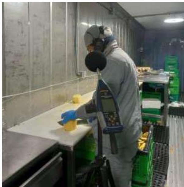
Ilustración 11 Medición de Ruido
