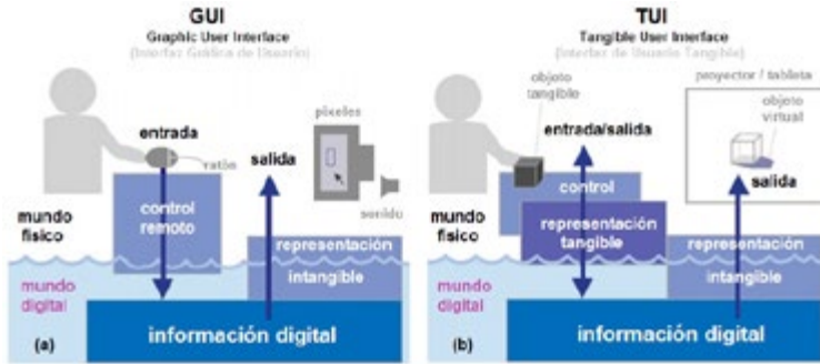
Figura 6: Modelo arquitectónico de las interfaces de usuario. En (a) Interfaces Gráficas de Usuario y en (b) Interfaces Tangibles de Usuario.
