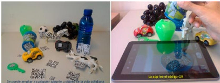
Figura 29: Prueba de un prototipo con códigos QR para identificación de objetos tangibles.
