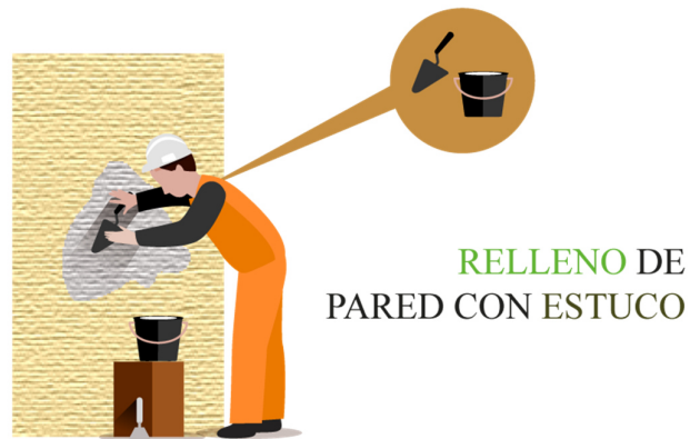
Gráfico 70: Aplicación de estuco en elemento afectado por erosión química.
