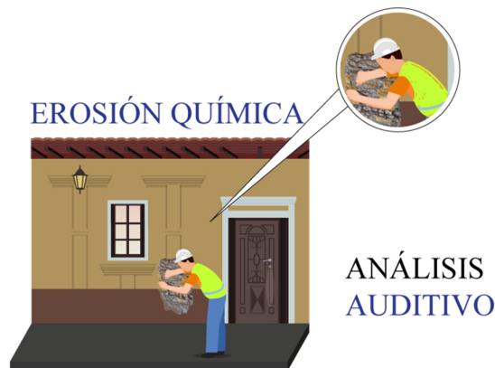
Gráfico 67: Identificación organoléptica de erosión química mediante el oído.
