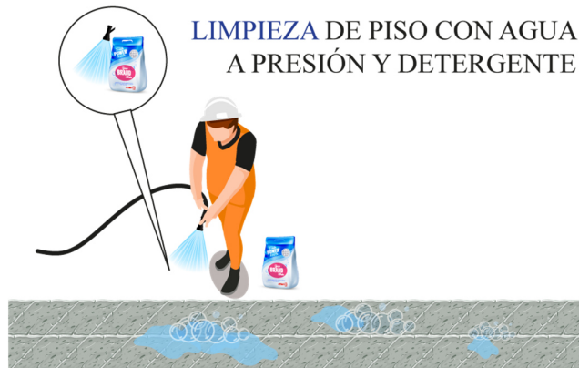
Gráfico 93: Limpieza con agua a presión y detergente.
