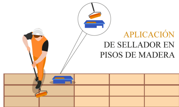
Gráfico 112: Aplicación de sellador para pisos.
