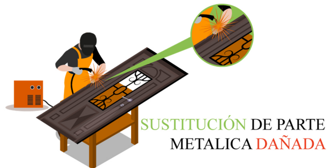
Gráfico 54: Sustitución de un metal con corrosión.
