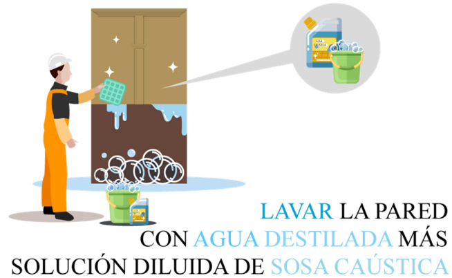
Gráfico 38: Limpieza con agua destilada y sosa cáustica.
