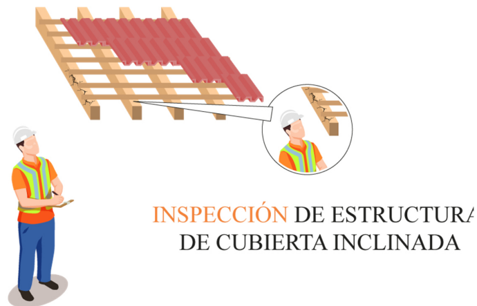
Gráfico 126: Inspección del estado de elementos estructurales.
