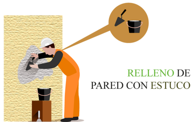
Gráfico 85: Tratamiento con estuco de erosión física.
