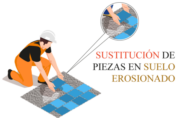
Gráfico 71: Sustitución del material afectado por erosión química.
