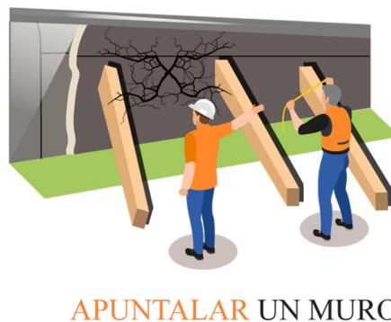
Gráfico 128: Medida temporal ante la afectación por grietas.
