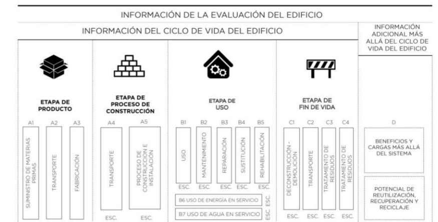
Gráfico 2 Esquema de organización de fases y módulos del ciclo de vida de un edificio
