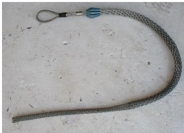
a) Extrusadora metálica para sujetar a cable eléctrico
