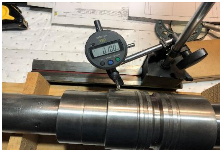
IMAGEN NO. 20 :CONTROL DE CALIDAD EN DEFLEXIÓN.
