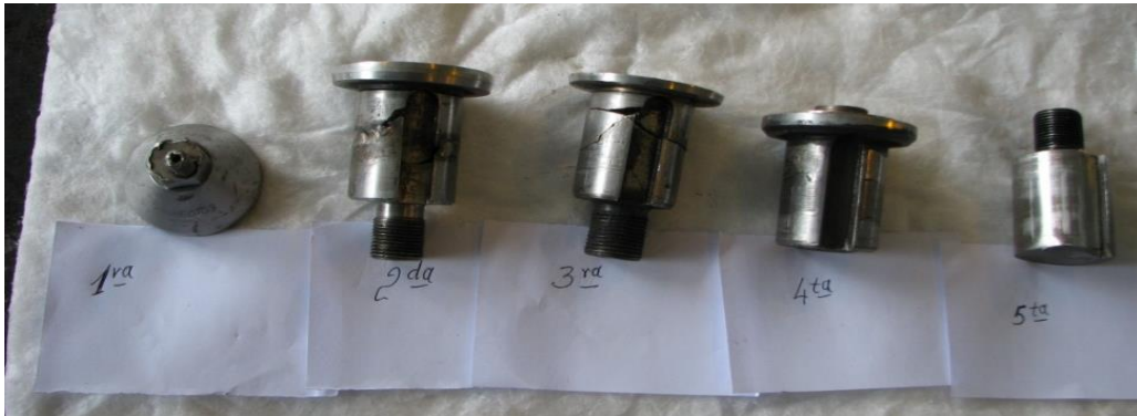
IMAGEN NO. 3: FALLAS ROTURAS SECUENCIAL EN EL EXTREMO DEL EJE EN ACOPLE IMPULSOR.
