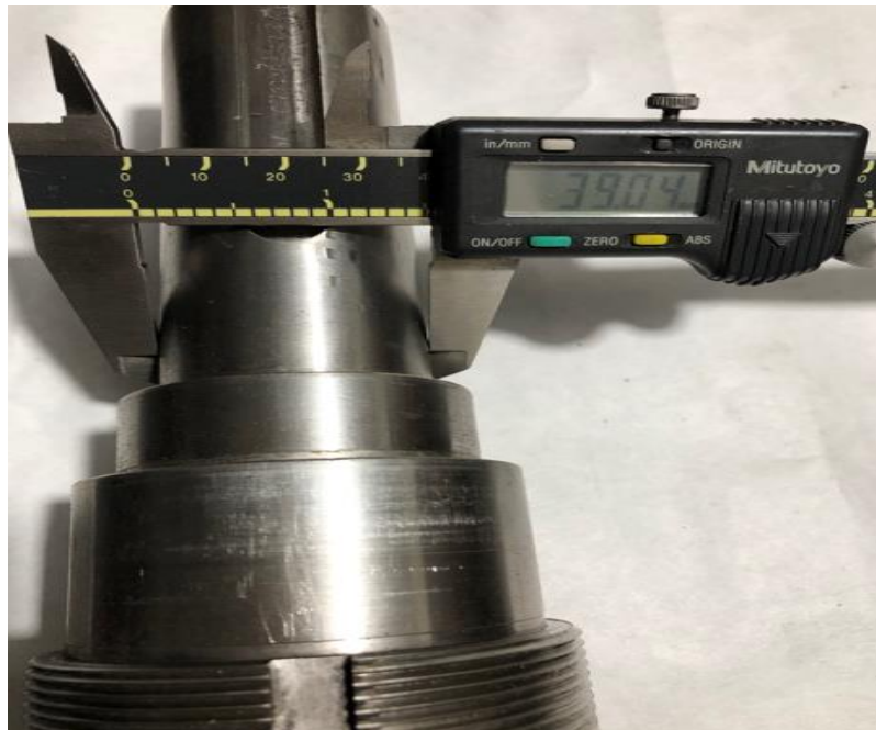
IMAGEN NO. 10: CONTROL DE CALIDAD EJE MEJORADO.
