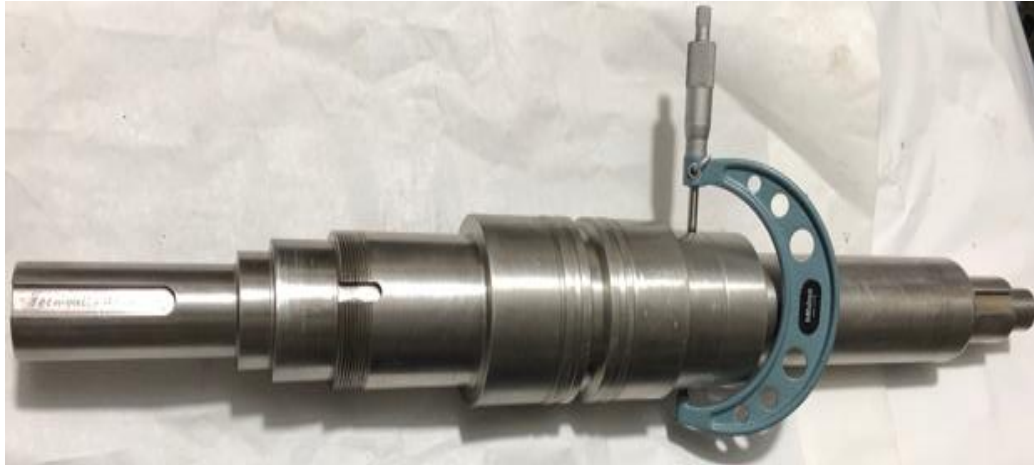
IMAGEN No. 11: CONTROL DE CALIDAD EJE MEJORADO.
