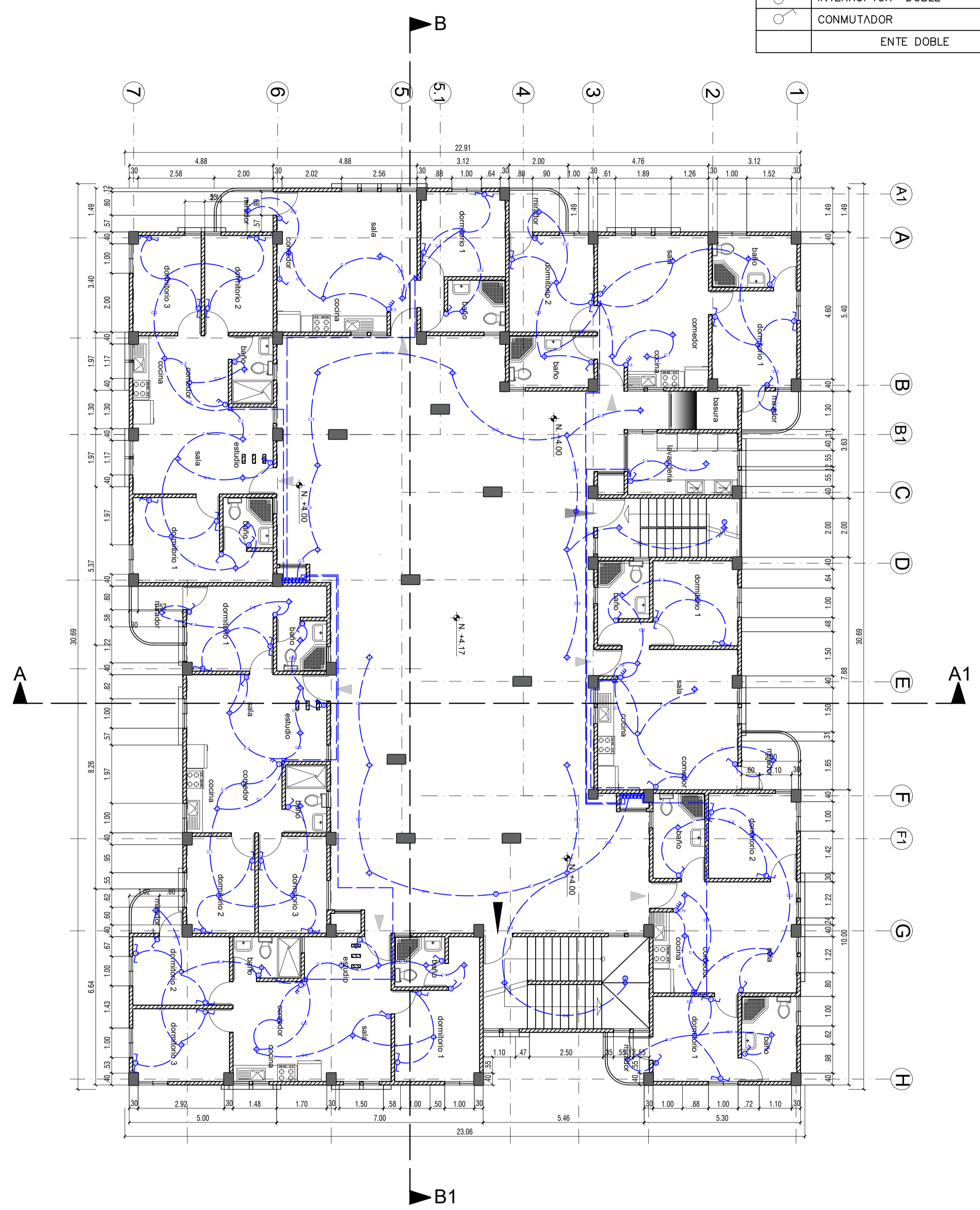
SEGUNDA PLANTA LUMINARIAS ESC 1:100
