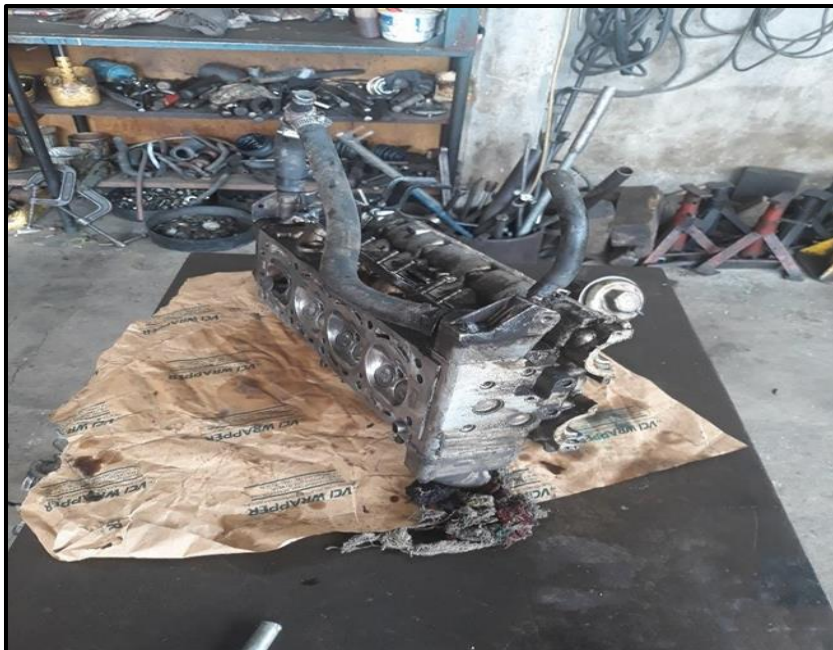
Anexo 4. Desmontaje de motor previo para la reparación
