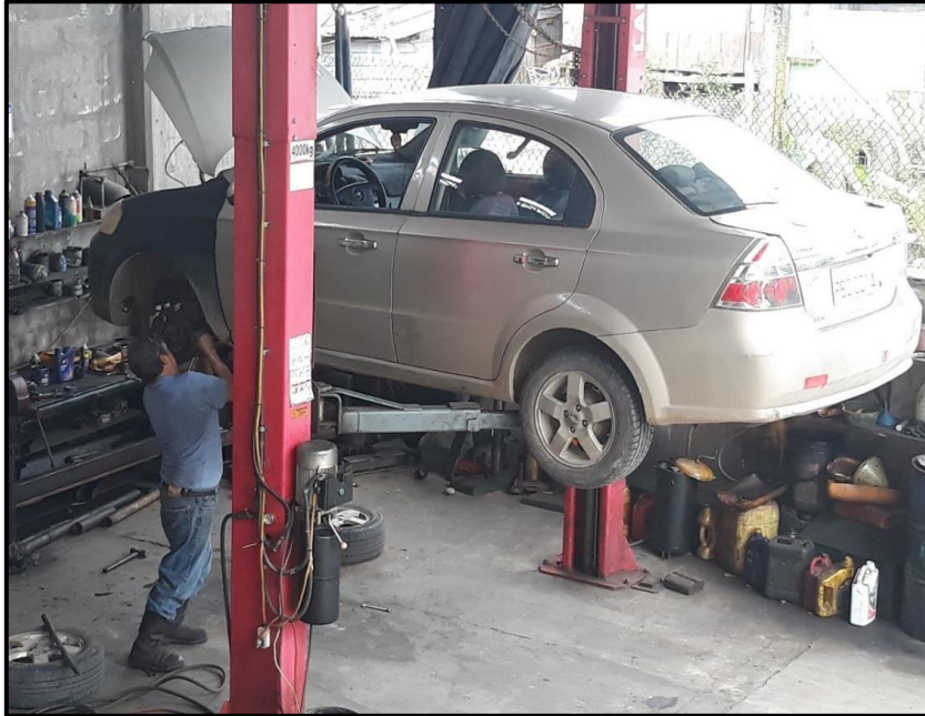
Anexo 3. Cambio de pastillas de frenos en el elevador hidráulico
