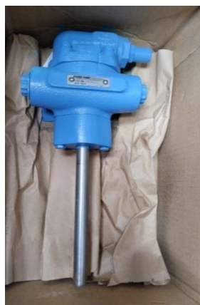
Imagen 8 Bomba de combustible Viking Fuente: (Inc, 2025)
