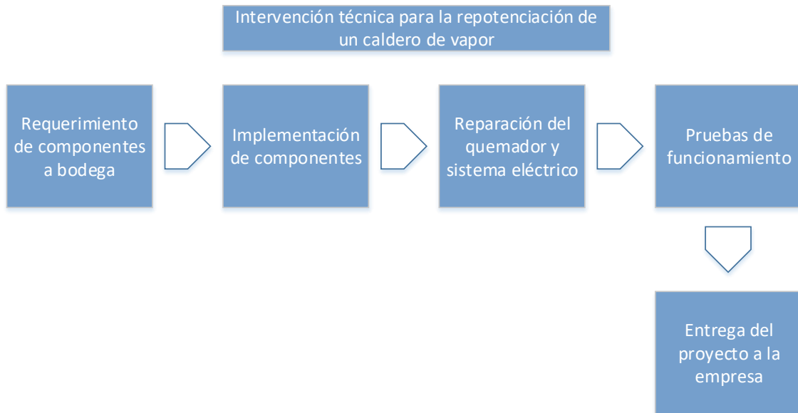
Imagen 5 Modelo Operativo de la intervención técnica en el caldero de vapor.
