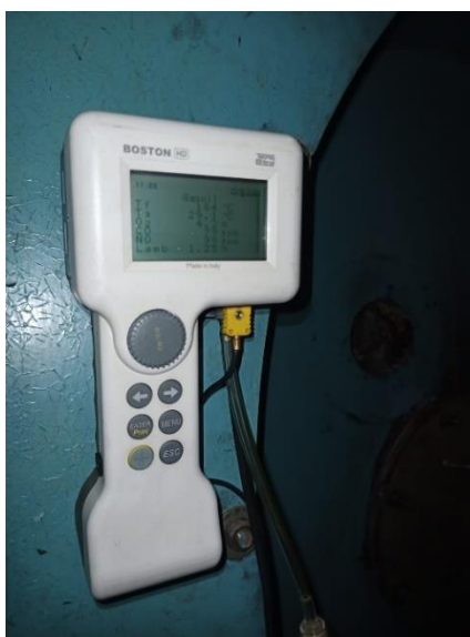
Imagen 33 Analizador de gases
