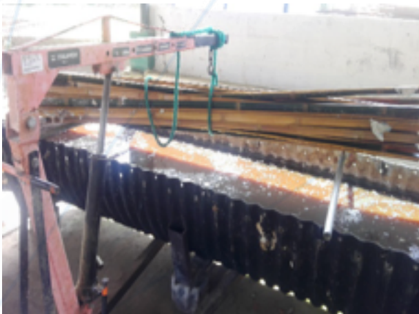
Figura 3. Proceso de preservado de latillas de bambú
