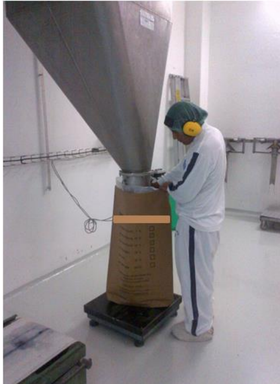
Imagen 15. Manipulación de fundas en el proceso de llenado antes de la readecuación Elaborado por: Cualchi, Luis (2024)
