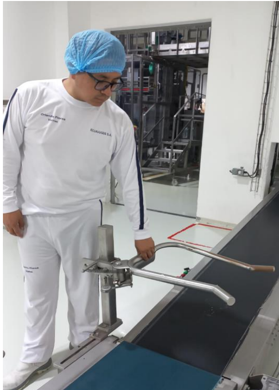
Imagen 19. Pruebas de Funcionamiento de brazo mecánico para voltear fundas Elaborado por: Cualchi, Luis (2024)
