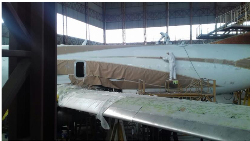
Imagen 5: Tareas de pintura
