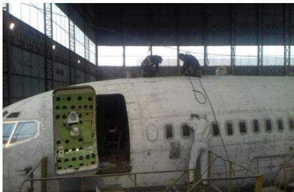
Imagen 3: Técnicos de estructuras y pinturas trabajando sobre el fuselaje del avión. Fuente: Centro de Mantenimiento Aeronáutico.
