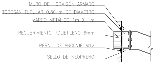
DETALLE ANCLAJE TOBOGÁN TUBULAR
