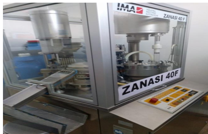
Figura 9 : Máquina dosificadora y encapsuladora ZANAS 40F
