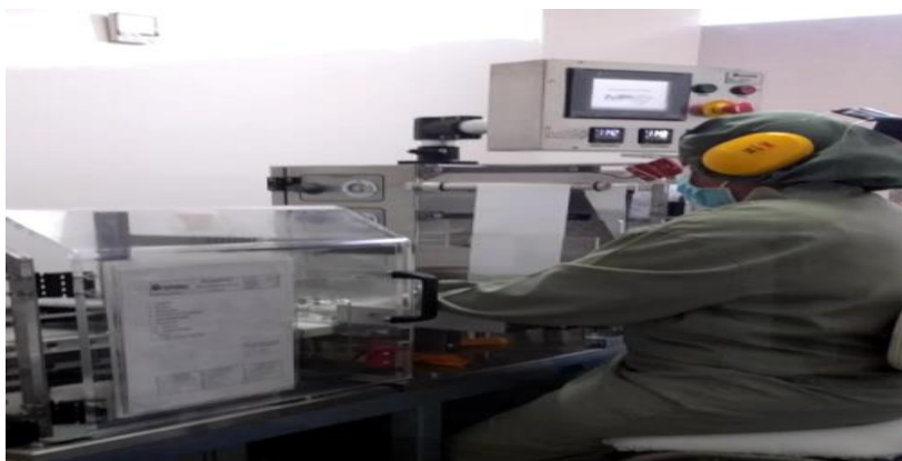
Figura 11: Proceso de blisteadado en máquina GB -100
