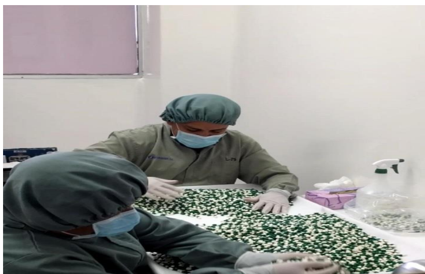
Figura 10: Esterilización de cápsulas e inspección visual por trabajadores
