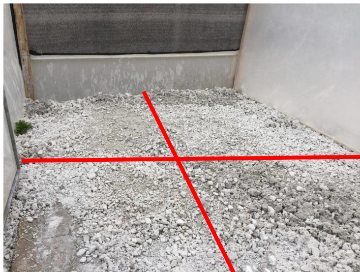
Ilustración 15: División del piso de la cámara de efecto invernadero 2
