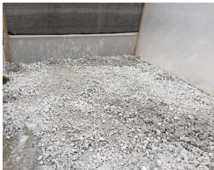
Ilustración 10: Lodos ubicados dentro de la cámara de secado Fuente: (Cedal S.A.).
