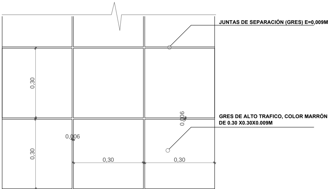
DETALLE, PISO DE GRES ESC: 1--10
