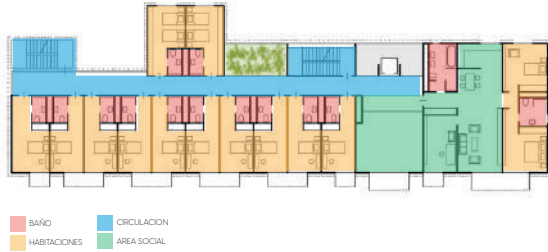
FIG.34.DISTRIBUCIÓN DE PLANTA ARQUITECTÓNICA
