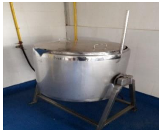
Figura 2: Tanque de Preparación
