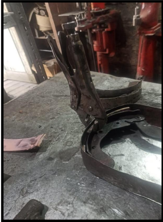
Anexo 3. Proceso de reparación y cambio de fibra de las zapatas de freno
