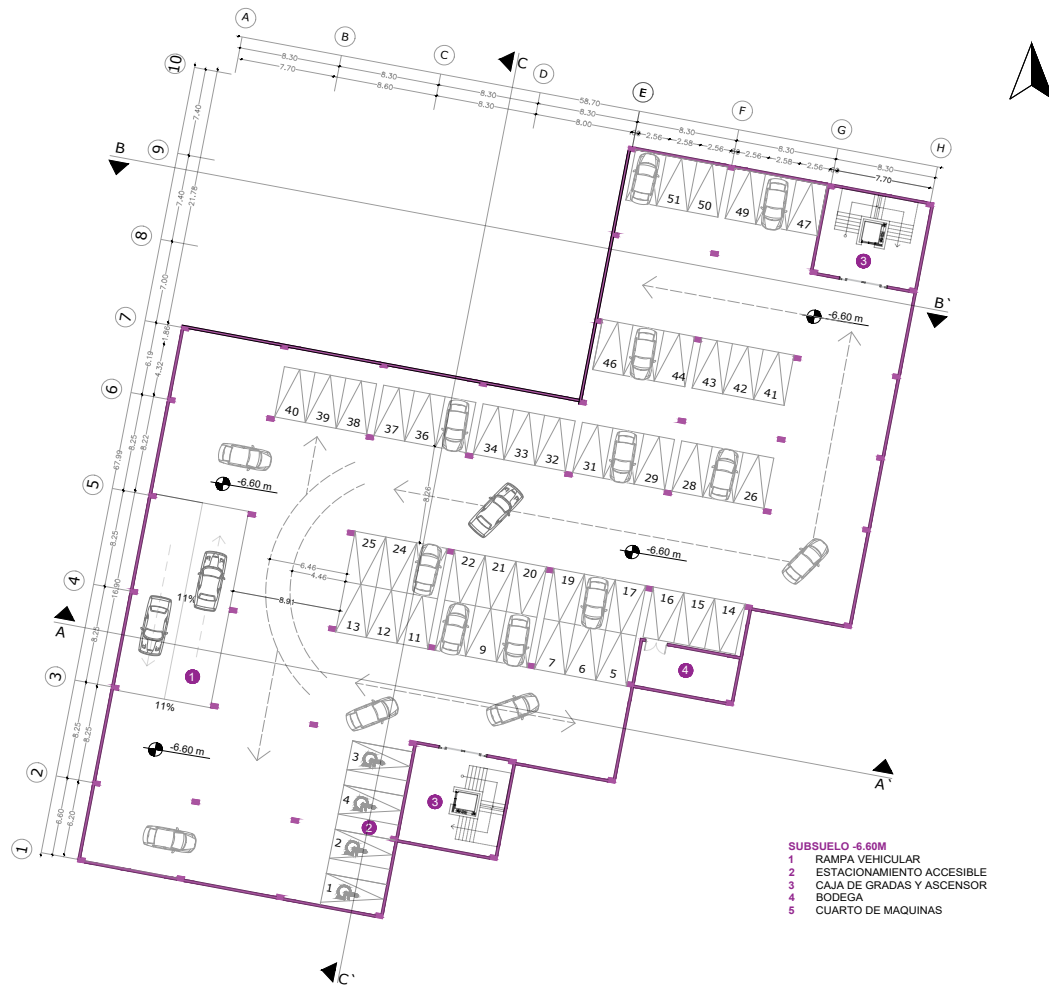
Figura 64. Sub suelo 2 nivel -6,60m
