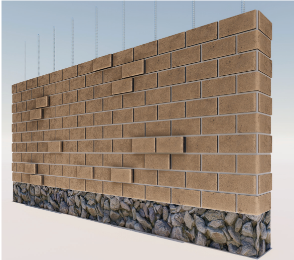
Figura 67. Render mampostería de adobe
