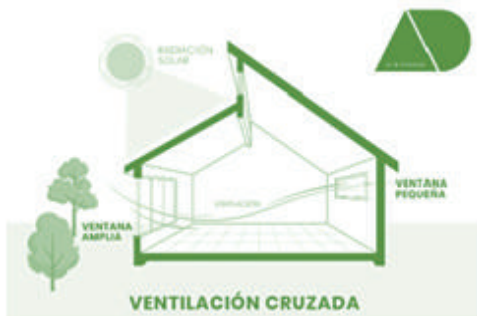
Figura 79. Ventilación natural cruzada
