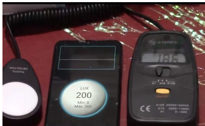
Imagen No. 7: Medición de iluminación Fotografía tomada por: Vargas, Danny (2024).
