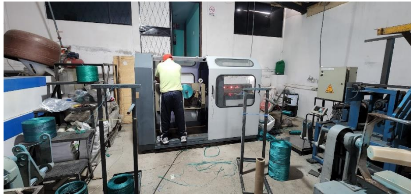
Imagen 4. Preparación y colocación de la rafia en la torcedora 1 Fuente: CORDEPLAST (2022).
