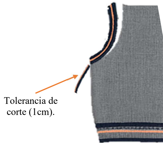
Imagen 9. Tolerancia de corte al coser las piezas. Fuente: Industria de tejidos Isratex.
