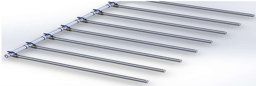
Imagen 21. Ensamble del sistema de distribución
