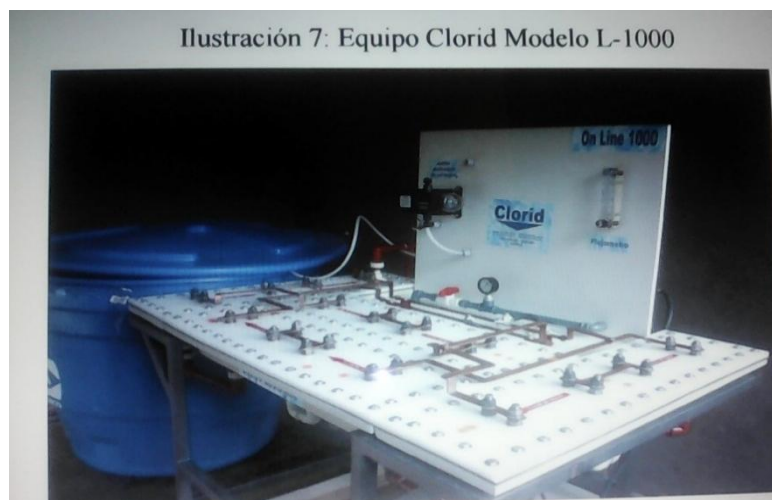
Figura 31: Generador de hipoclorito de sodio modelo 1000
