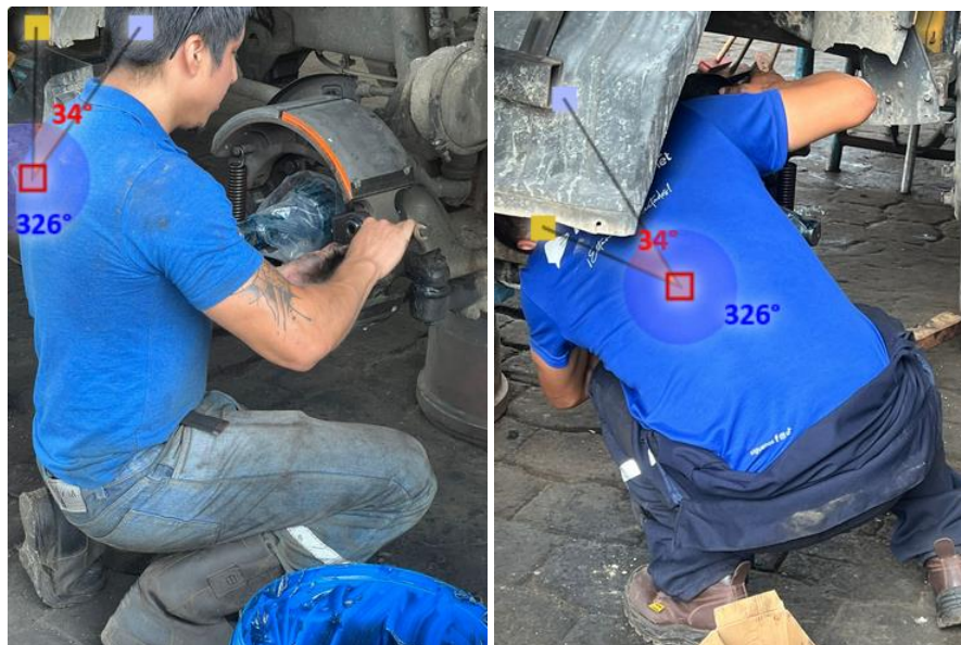
Imagen 13. Mantenimiento de frenos posturas inadecuadas. Elaborado por: Zabala, Pablo (2024).
