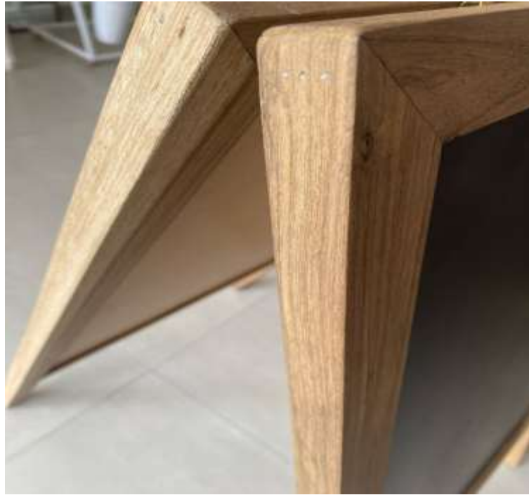
Ilustración 6. Esquinas del pizarrón ensambladas con la clavadora neumática.
