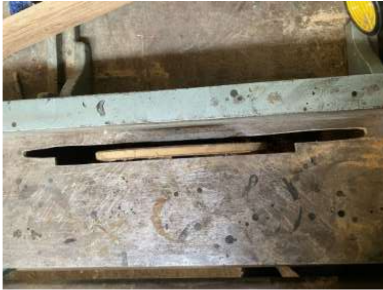
Ilustración 2. Sierra de mesa con la modificación para lijado
