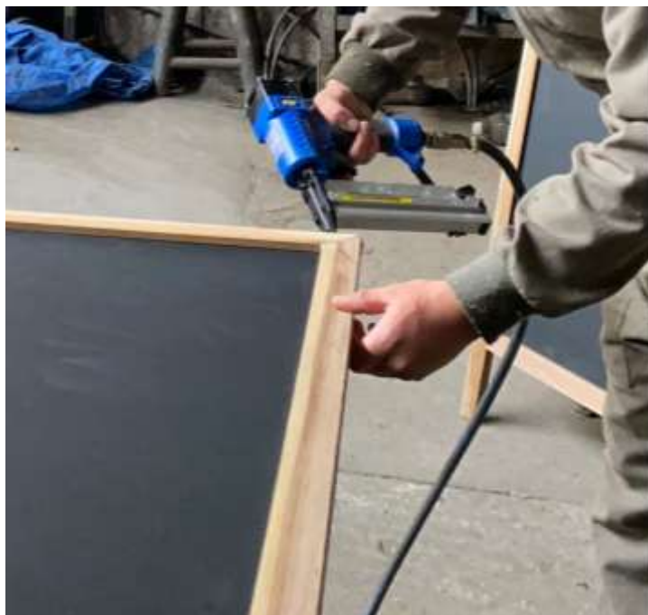
Ilustración 5. Clavado de las esquinas del pizarrón con la clavadora neumática.
