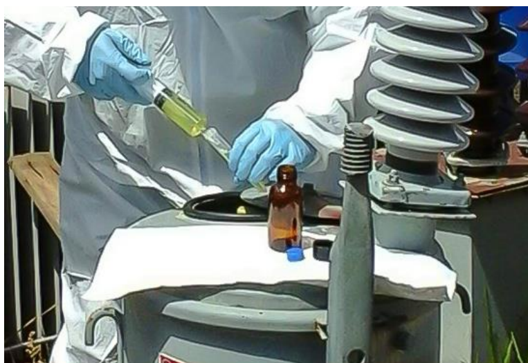
Imagen 2. Área para pruebas de aceite dieléctrico y PCBs Fuente: Flores, Ángel (2023)
