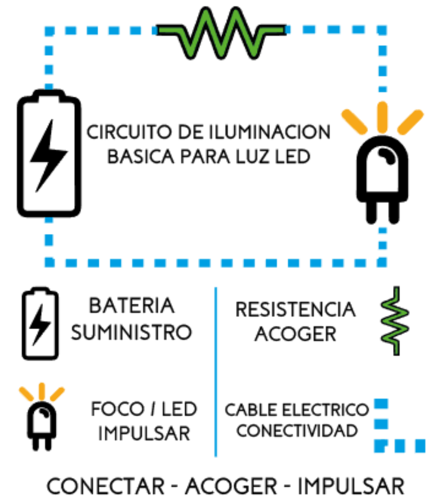
Gráfico 65: Circuito de iluminación de un led (Proyección de lo que es la función del centro de innovación abierta)
