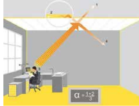
Figura O9. Onda sonora que choca con un obstáculo Tomado de (Conocimiento acústico| Visión general | Ecophon, s/f)
