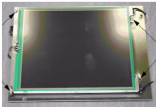
Figura N° 33: Retiro y colocación de pantalla touch
