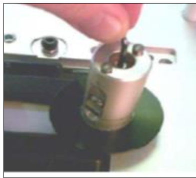
Figura N° 61: Retiro de tornillos de sujeción de mandriles
